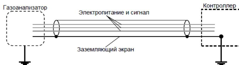
Рисунок 14 – Заземление экранированного кабеля
