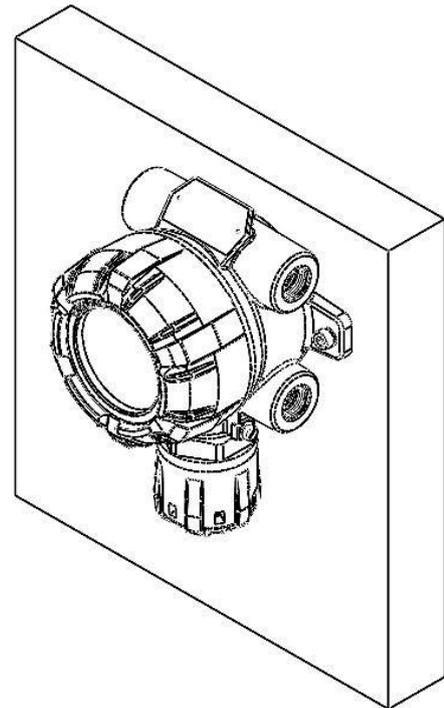
Рисунок 6 – Вид газоанализатора, установленного на стену
