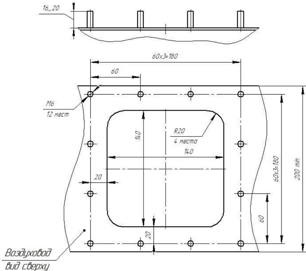
Рисунок 9 – Место для установки комплекта
