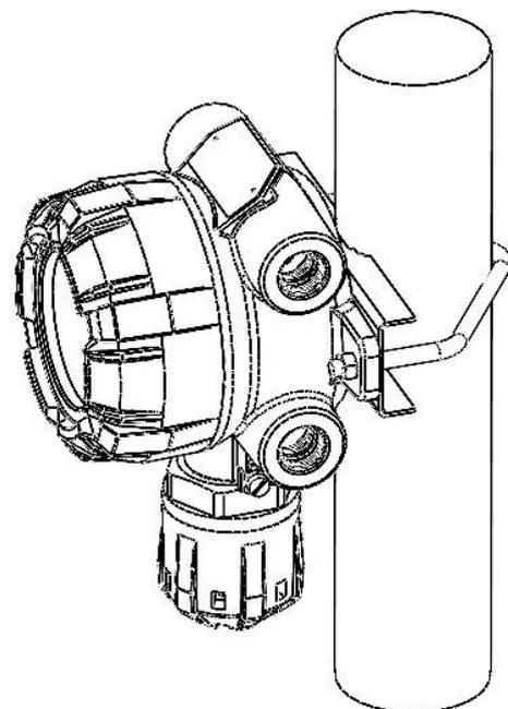
Рисунок 8 – Вид газоанализатора, установленного на трубу
