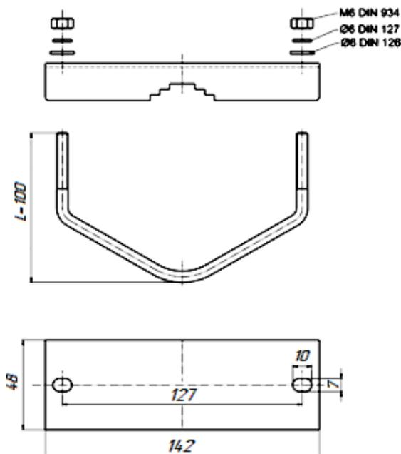
Рисунок 7 – Вид крепления для установки на трубу
